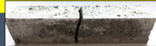
Eprouvette de pâte de ciment CEM-I 52.5R contenant 20% de scories carbonatées
