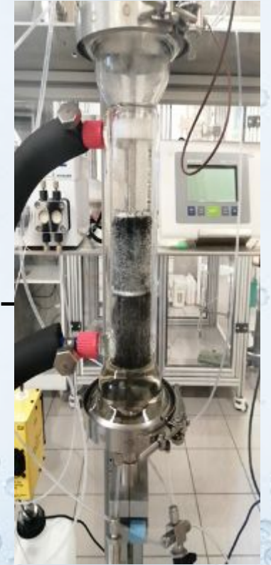
B : Réacteur à lit élastique Petites bulles avec une augmentation de l'aire interfaciale
